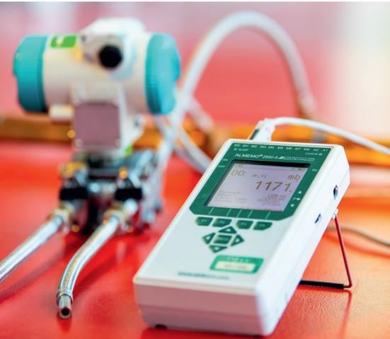
*Vorbereitung einer Differenzdruckmessung mit hoher Messgenauigkeit*
